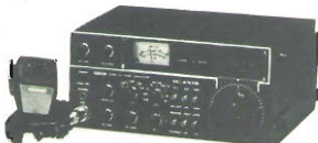
IC 251 E: ricetrasmittitore per i due metri in SSB-CW-FM-CPU - da 144 a 149 Mhz - doppio VFO 3 canali a memoria 10 W PEP in SSB.
